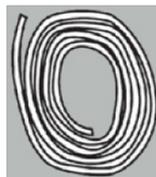
Приклейте прилагаемый уплотнитель вдоль нижнего края варочной панели, убедившись, что концы перекрываются.
