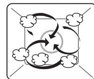
Камера нагревается одновременно паром и горячим воздухом. Продукт подогревается или приготавляется на пару.
