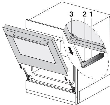
**!** Убедитесь, что дверца прибора установлена до упора, в противном случае возможно повреждение прибора при закрывании дверцы.
