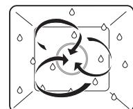
Воздух в камере нагревается нагревательным элементом, расположенным за задней стенкой камеры, и равномерно циркулирует. Влага, выделяемая продуктом, выводится из камеры в минимальном объеме. Влажность продукта сохраняется.
