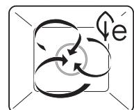
Данный режим работы особенно энергосберегающий. Воздух в камере нагревается нагревательным элементом, расположенным за задней стенкой камеры, и равномерно циркулирует. Влага, выделяемая продуктом, остается в камере. Приготовляемое блюдо не пересыхает.
