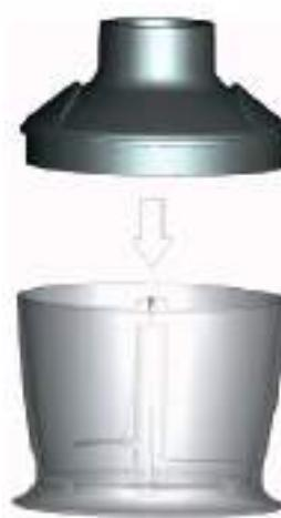
Закрепите блок двигателя на чаше измельчителя.
