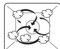
Камера нагревается одновременно паром и горячим воздухом. Продукт подогревается или приготавляется на пару.
