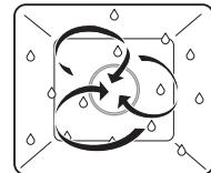
Воздух в камере нагревается нагревательным элементом, расположенным за задней стенкой камеры, и равномерно циркулирует. Влага, выделяемая продуктами, выводится из камеры в минимальном объеме. Влажность продукта сохраняется.
