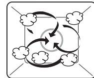
Камера нагревается одновременно паром и горячим воздухом. Продукт подогревается или приготовляется на пару.
