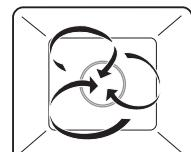
Воздух в камере нагревается нагревательным элементом, расположенным за задней стенкой камеры, и равномерно циркулирует.
