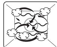
Во время приготовления на пару продукт дополнительно обрабатывается автоматически включающимися микроволнами, вследствие чего сокращается время приготовления.
