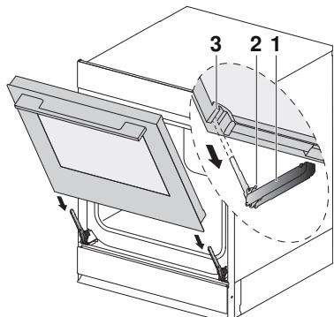
**!** Убедиться, что дверца прибора установлена до упора, в противном случае возможно повреждение прибора при закрывании дверцы.
