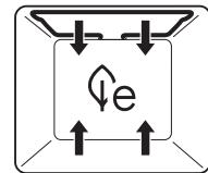
Данная программа особенно энергосберегающая. Нагрев осуществляется с помощью верхних и нижних нагревательных элементов. Влага, выделяемая продуктом, остается в камере. Приготовляемое блюдо не пересыхает.
