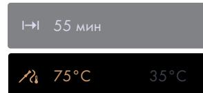
Если готовое блюдо остается в камере после выключения прибора, то воздействие остаточного тепла может привести к повышению температуры сердцевины.
