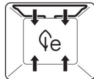
Данная программа особенно энергосберегающая. Нагрев осуществляется с помощью верхних и нижних нагревательных элементов. Влага, выделяемая продуктом, остается в камере. Приготовляемое блюдо не пересыхает.
